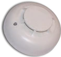
Le détecteur thermovélocimétrique algorithmique AE/SA-T d'Aguilera Electrónica est un détecteur de chaleur qui gère deux paramètres de température, un différentiel qui mesure l'augmentation de la température dans le temps et un autre terme qui contrôle la température ambiante qu'il détecte à tout moment. Le paramètre différentiel et le paramètre thermique sont analysés et envoyés au panneau de commande pour ce signal d'alarme selon la programmation effectuée dans chaque cas.
