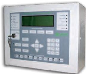
Centrale incendie intelligente avec capacité pour 1 boucle de 125 unités, à laquelle sont connectés les détecteurs, boutons-poussoirs, modules de manœuvre, modules de commande et autres éléments qui composent l'installation.
