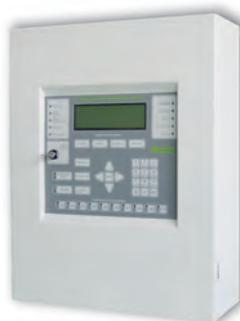
Centrale de détection incendie intelligente avec bus pour le raccordement de 1 à 4 cartes AE/SA-CTL. Chaque carte contrôle deux boucles algorithmiques bidirectionnelles, d'une capacité de 125 appareils chacune, auxquelles sont connectés les détecteurs, boutons poussoirs, modules de manœuvre, modules de commande et autres éléments qui composent l'installation.
